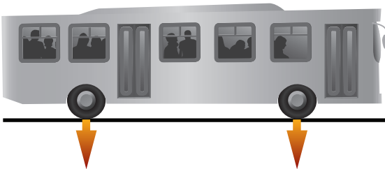
Σχήμα 3.5 Ομοιόμορφη και ανομοιόμορφη επί των αξόνων φόρτωση.
